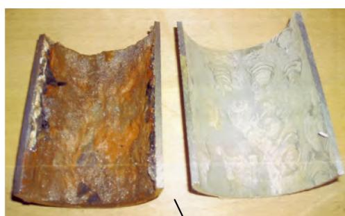
\*切取管を半割にし、片方を洗浄し、配管内部の腐食状況を確認する。
